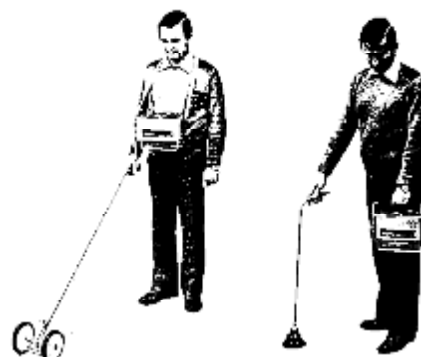
Obr. 16.19: Vyhledávání úniku plynů na podzemních plyn. zařízeních
